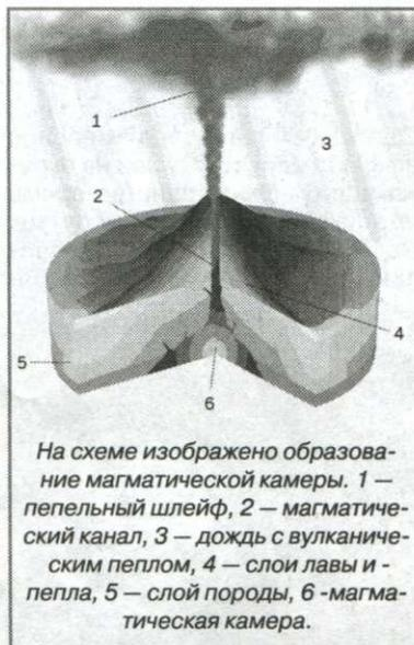
На схеме изображено образование магматической камеры. 1 — пепельный шлейф, 2 — магматический канал, 3 — дождь с вулканическим пеплом, 4 — слои лавы и пепла, 5 — слой породы, 6 — магматическая камера.
